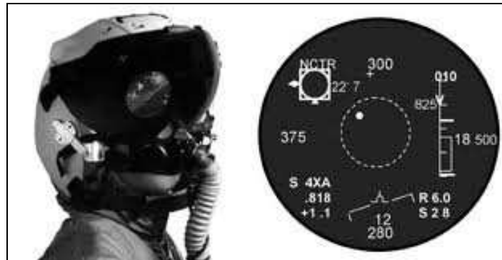
Fot. 3. Widok hełmu z elementami systemu zobrazowania sytuacji taktycznej (po lewej), obraz z systemu nahałmowego sterowania uzbrojeniem w chwili ataku (po prawej)
