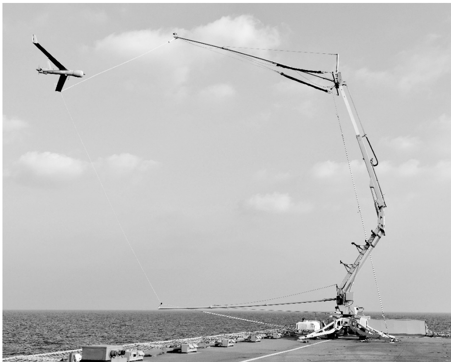
Rys. 1. Urządzenie „Sky Hook” BSP Scan Eagle jako przykład zastosowania systemu startu i przechwytywania na okręcie
