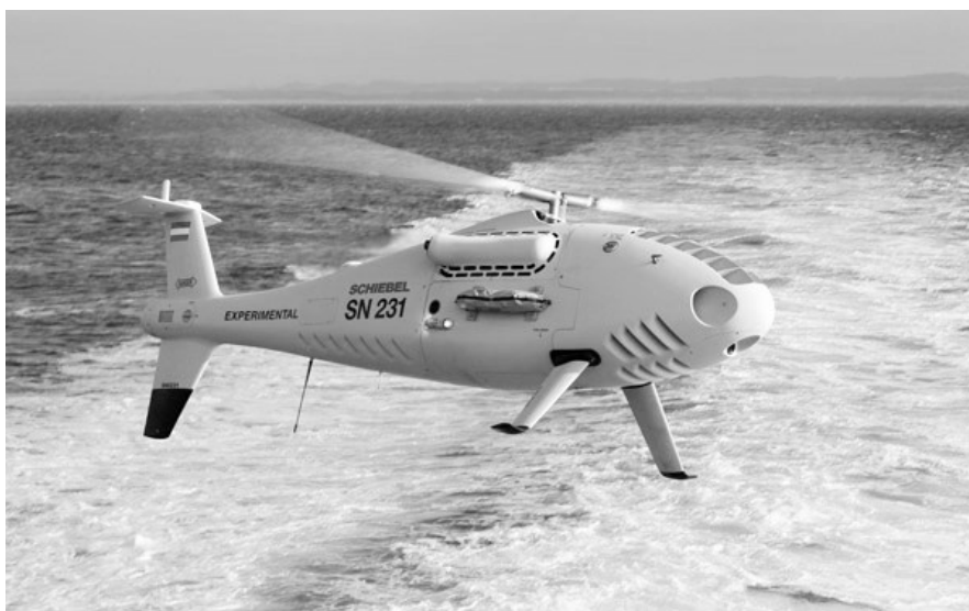
Rys. 2. Przykład BSP typu VTOL – Camcopter S-100
