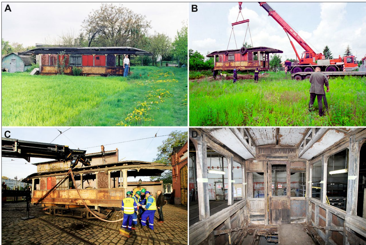
Ryc. 3. Stan nadwozia przed restauracją: A – nadwozie jako altanka ogrodowa w Smolcu w 2002; B – transport nadwozia ze Smolca do Wrocławia w 2002; C – zdejmowanie nadwozia z prowizorycznego podwozia przed rozpoczęciem restauracji w 2014; D – wnętrze nadwozia przed restauracją w 2014; fot. P. Drab (A, B), K. Kokot (C, D).
