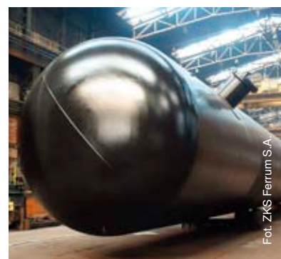
Fot. 4. Jedne z największych zbiorników LPG, produkowane w wytwórni ZKS Ferrum S.A.
