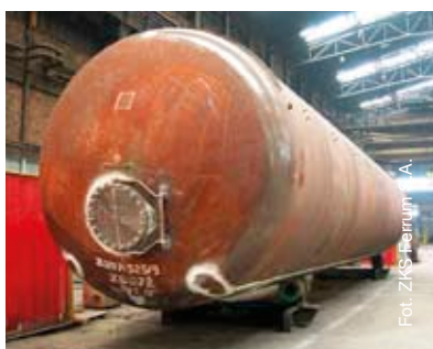
Fot. 2. Etap końcowej prefabrykacji zbiornika magazynowego LPG
