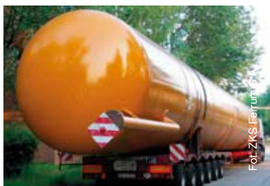
Fot. 3. Gotowy do transportu zbiornik magazynowy LPG, przewidziany docelowo do zakupowania
