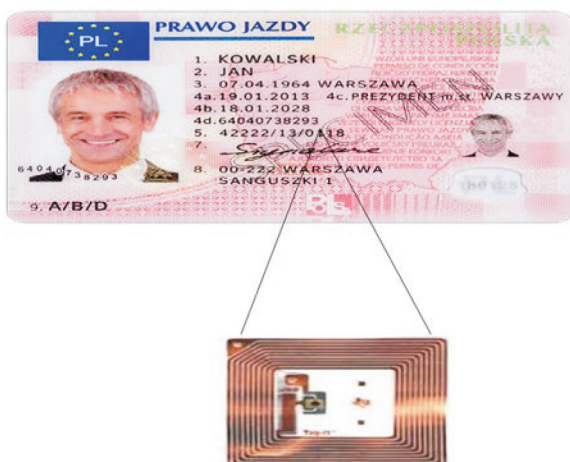
Rys. 3. Rysunek przedstawiający pomysł umieszczenia etykiety RFID we wnętrzu dokumentu prawa jazdy
