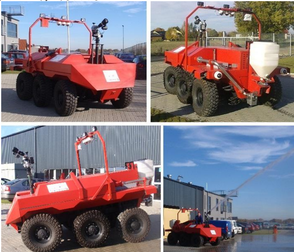
Rys. 6. Zdalnie sterowana, bezzałogowa platforma lądowa do zadań zmniejszenia zagrożenia wywołanego niekontrolowanym uwalnianiem substancji niebezpiecznych
