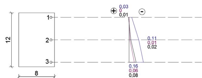
Rys. 7. Odształcenia betonu na wysokości przekroju dla 20 kN (czarna linia i fioletowa – belka z użyciem kruszywa z recyklingu, a niebieska linia belka jednorodna z betonu z użyciem kruszywa naturalnego) [5]
