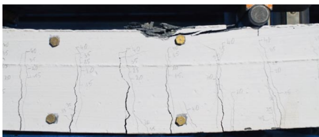
Rys. 10. Rozwój rys w wybranej badanej belce z użyciem kruszywa naturalnego [5]
