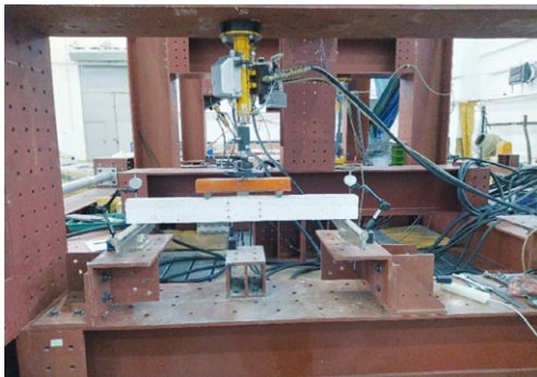
Rys. 3. Stend badawczy z belką przygotowaną do badań [5]
