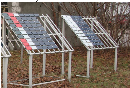
Rys. 1. Badania powłok epoksydowych na stacji klimatycznej
