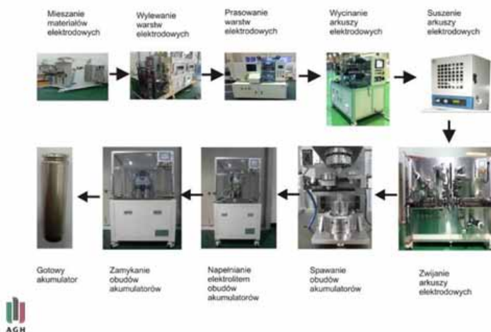
Rys. 6. Wyposażenie Laboratorium badawczo-wdrożeniowego ogniw litowych i sodowych w Centrum Energetyki AGH: (a) Wysokociśnieniowy reaktor chemiczny do syntezy materiałów w powiększonej skali, (b) półautomatyczna linia montażu ogniw Li-ion w obudowach cylindrycznych 18650
