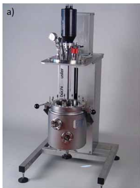
Rys. 6. Wyposażenie Laboratorium badawczo-wdrożeniowego ogniw litowych i sodowych w Centrum Energetyki AGH: (a) Wysokociśnieniowy reaktor chemiczny do syntezy materiałów w powiększonej skali, (b) półautomatyczna linia montażu ogniw Li-ion w obudowach cylindrycznych 18650
