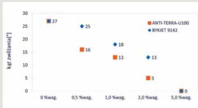
Rys. 5. Wyniki kąta zwilżania podłoża przez atramenty ceramiczne z różną zawartością BYKJET 9142 i ANTI-TERRA-U 100.
