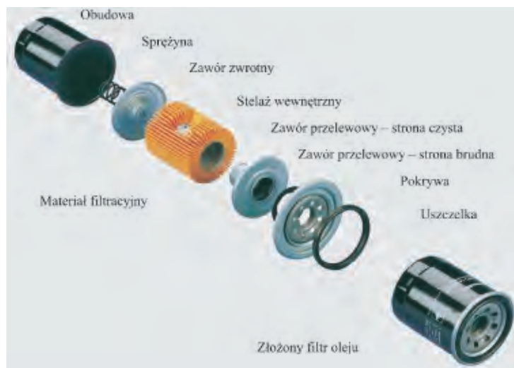
Rys. 1. Filtr oleju silnikowego (schemat budowy) [10]
