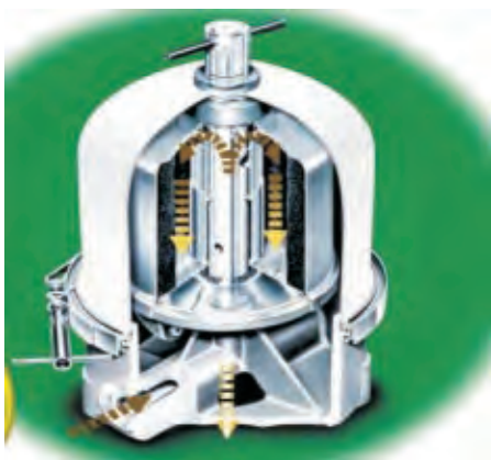
Rys. 4. Filtr odśrodkowy Mann and Hummel (Mann & Hummel Centrifuge Oil Cleaner)
