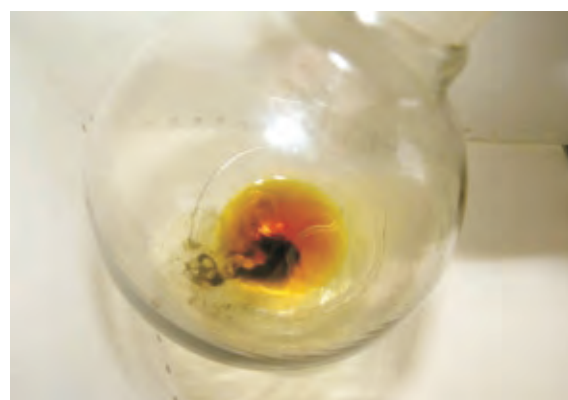
Rys. 10. Pozostałość z dializy, z wydzielającymi się aglomeratami sadzy
