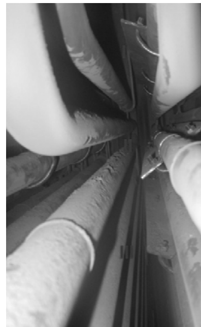
Rys. 1. Symulowane ożebrowanie diagonalne podczas badań możliwości samooczyszczania z osadów popiołowych
