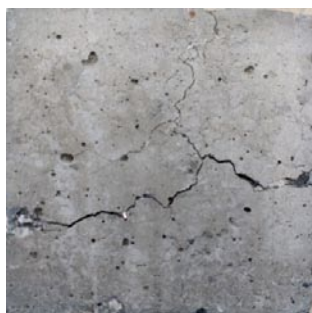
Rys. 2. Pęknięcia ścian próbki zarobów; od lewej: Z4-69, Z5-50, Z7-63
