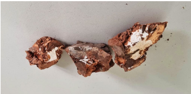
Ryc. 3. Próbkę gruntu z zawału tunelu TD-2.1 z widocznymi pozostałościami kleju
