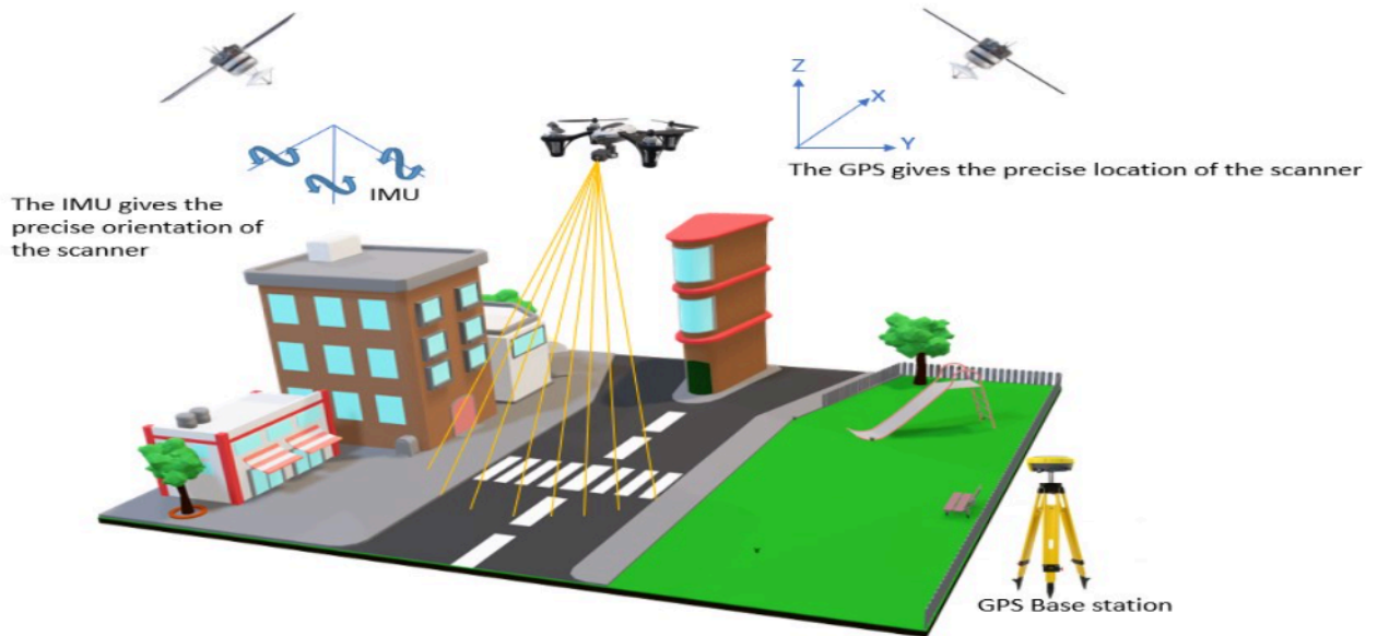
Fig. 3. Working principle of ALS
