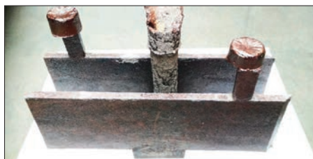
Rys. 14. Odlew stopu \text{Cu}94\% + (\text{Ce}+\text{La})6\% z wytopu N 238
