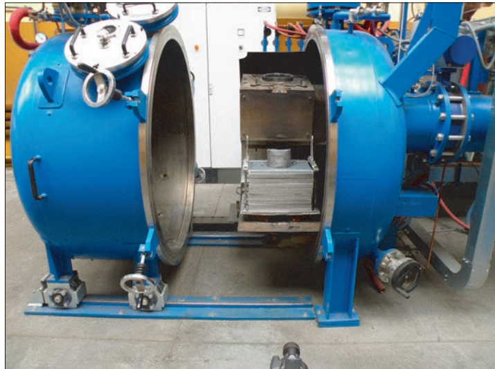
Rys. 11. Stanowisko próżniowego pieca indukcyjnego – przed wytopem
