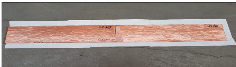
Rys. 15. Odlane i przeszlifowane 2 płyty stopu \text{Cu}94\% + (\text{Ce}+\text{La})6\% z wytopu N 238
