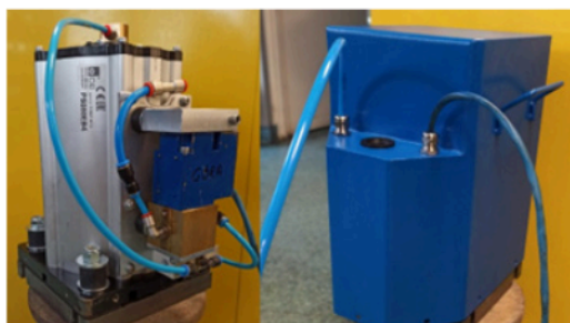
Rys. 2. Zdjęcia prototypu zoptymalizowanego wzbudnika WZB Typ 2 z płytą uderową i obudową Fig. 2. Photos of the optimized seismic source prototype WZB Type 2 with an baseplate and steel case
