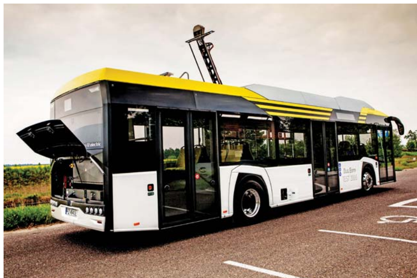
Tylna ściana z otwartą komorą zestawu baterii i elementów sterowania mocą. Na dachu widoczny jest pantograf szybkiego ładowania
