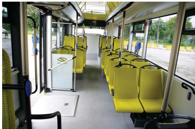
Mocowanie siedzeń metodą canti-lever
