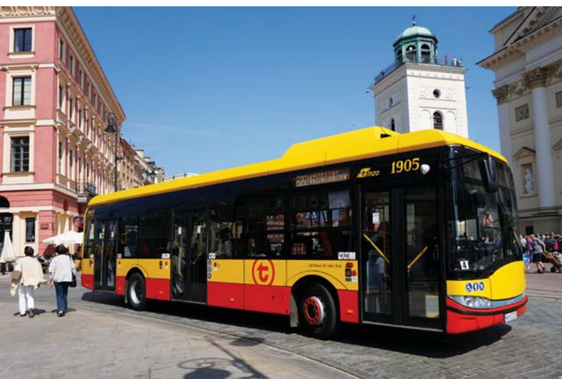
Solaris Urbino 12 electric dla Warszawy: a) na Krakowskim Przedmieściu, b) z charakterystycznym podestem naprzeciwko środkowych drzwi, pod którym umieszczony jest centralny silnik trakcyjny
