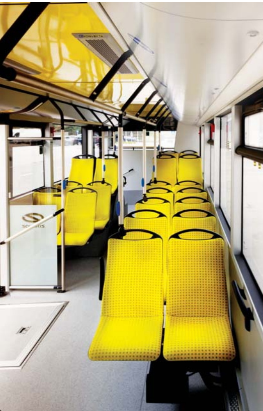
Solaris Urbino wyróżniał się na tle konkurencji dużą liczbą miejsc siedzących dostępnych bezpośrednio z niskiej podłogi
