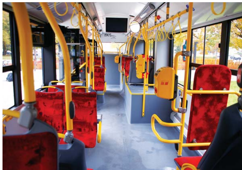
Solaris Urbino 12 electric dla Warszawy: a) na Krakowskim Przedmieściu, b) z charakterystycznym podestem naprzeciwko środkowych drzwi, pod którym umieszczony jest centralny silnik trakcyjny
