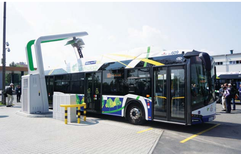
Solaris Urbino 12 electric podczas procesu doładowania baterii za pomocą pantografu w MPK Kraków
