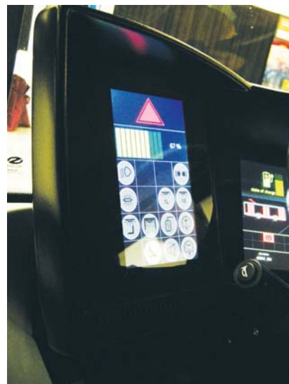
Na desce rozdzielczej pojawił się nowy piktogram informujący kierowcę o stanie naładowania baterii oraz o optymalnym położeniu pojazdu przy podejściu pod ładowarkę pantografową
