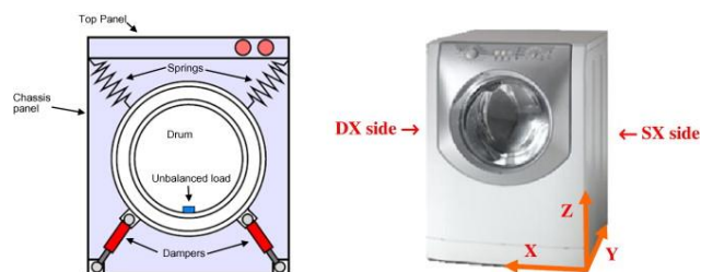
Rys. 6. Zawieszenie bębna pralki automatycznej z wykorzystaniem tłumików MR [2]
