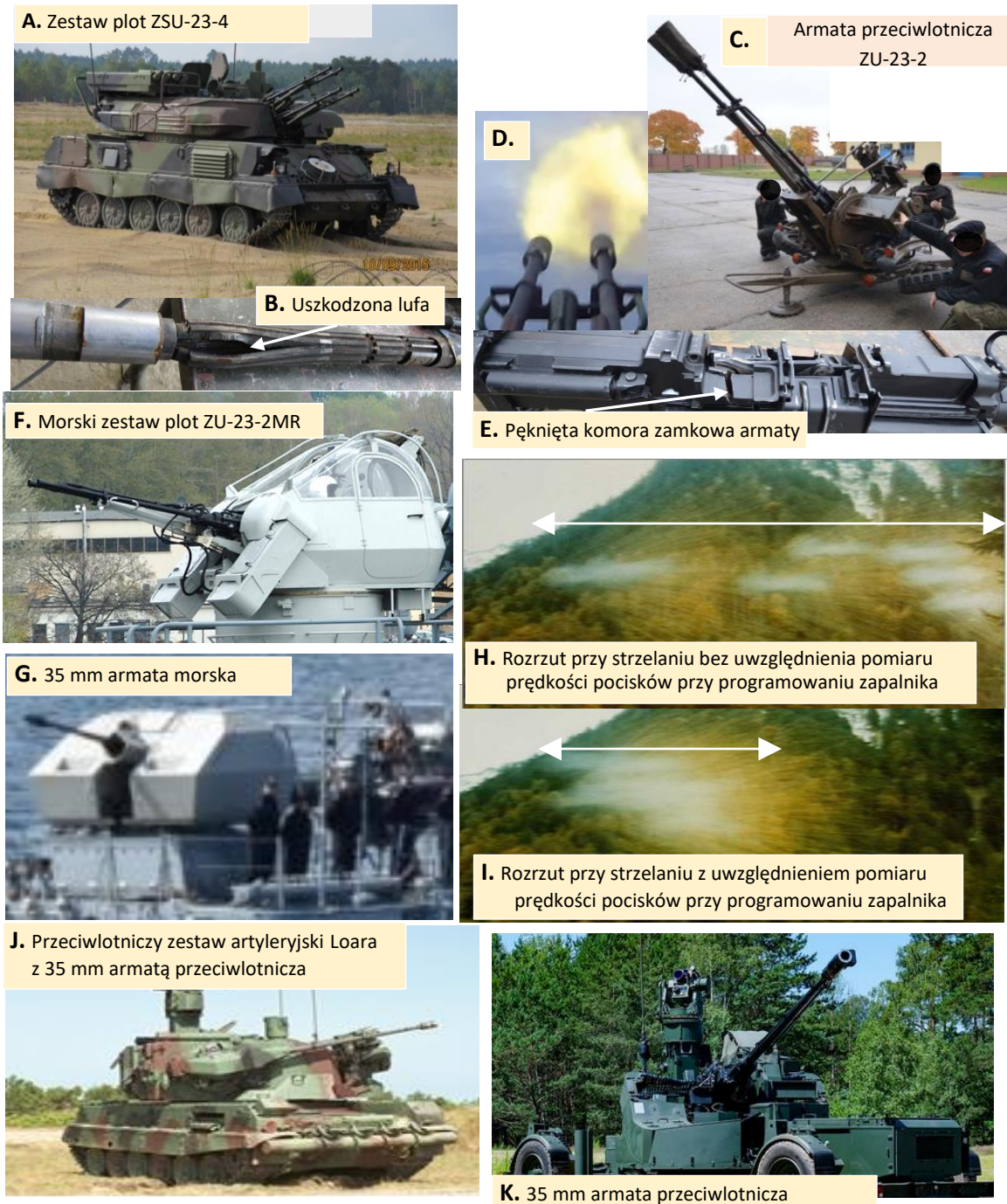
Rys. 2. Porównanie rozrzutu zadziałania 35 mm pocisków AHEAD na cel bez pomiaru prędkości na wylocie z lufy (H) i z uwzględnieniem pomiaru prędkości pocisku (I) przy celu stacjonarnym znajdującym się w odległości 1600 m od wylotu lufy [10]; przykłady zastosowań armat plot: J - przeciwlotniczy zestaw artyleryjski Loara (RADWAR S.A), K - armata holowana San jako model laboratoryjny 35 mm automatycznej armaty KDA (RADWAR S.A) [29] (A. B. C. D. E. - fot. Z. Idziaszek) (F. G. H. I. K. - fot. PIT-RADWAR) (J. - fot. Z. M.)
