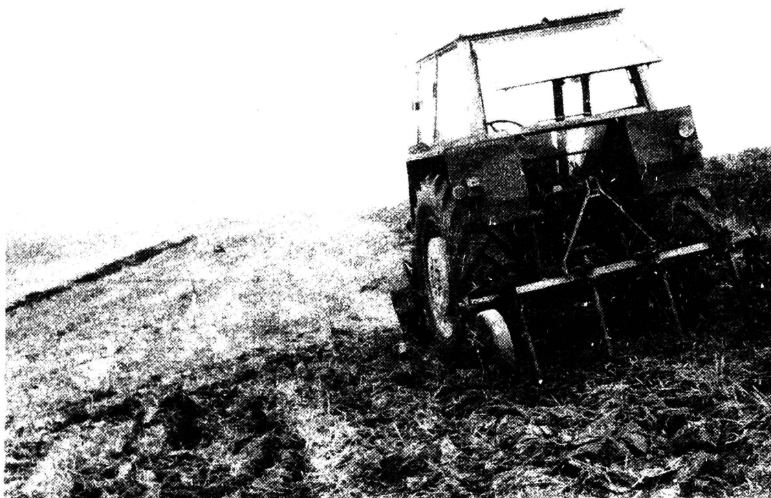
Rys. 3. Narzędzie bezodkładnicowe własnej konstrukcji zawieszona na ciągniku Ursus C-385
