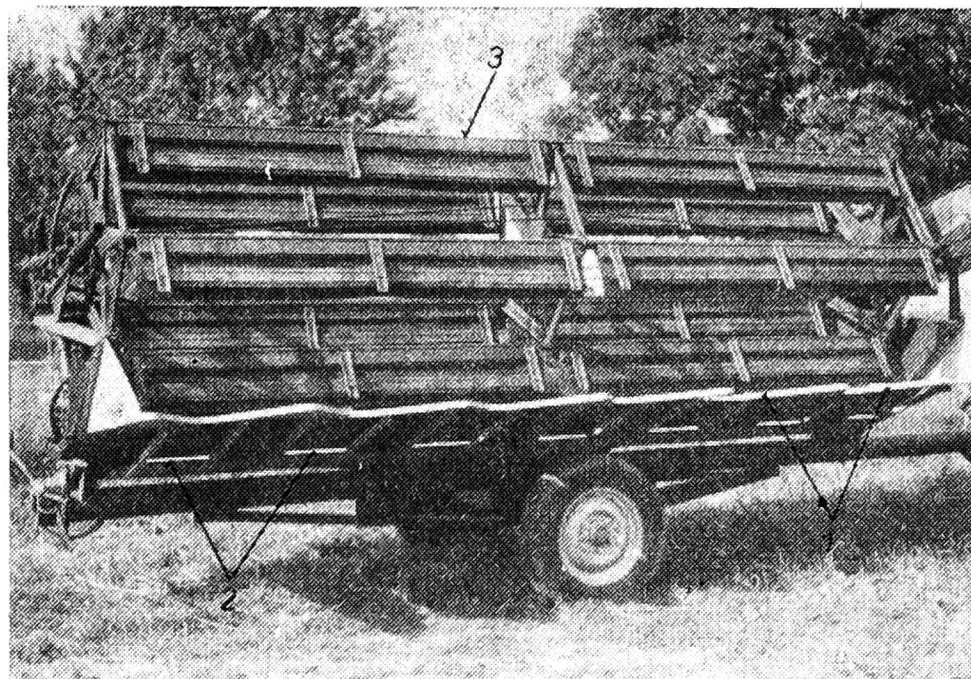
Rys. 1. Urządzenie do zbioru słonecznika na ziarno US-1 zamontowane na zespole żniwnym kombajnu Bizon Z-040: 1 — wanianki, 2 — rolki oporowe, 3 — zmodyfikowany nagarniacz
