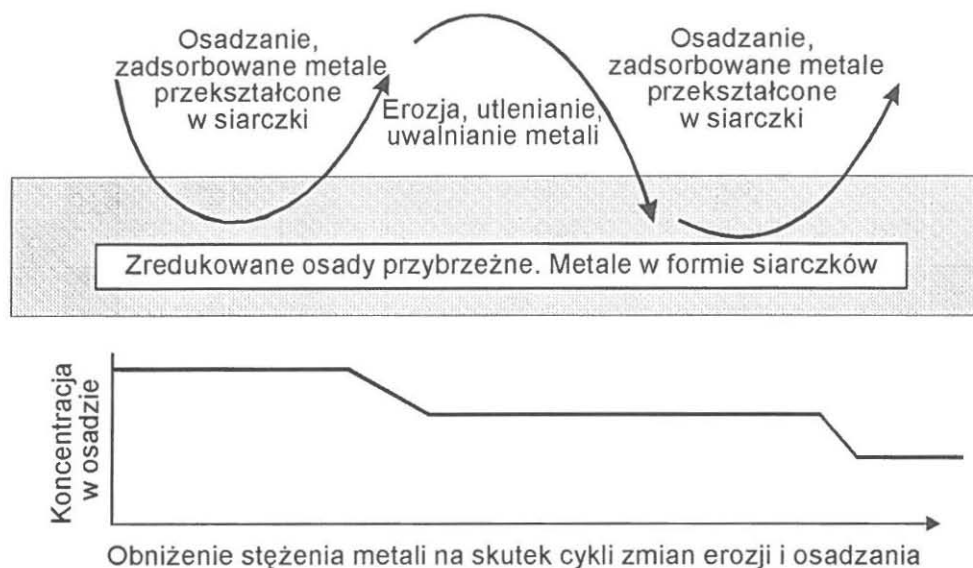
Rys. 13. Obniżenie stężenia metali w osadach przybrzeżnych na skutek cyklicznych procesów erozji i osadzenia [12]
