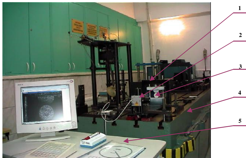
Rys. 1. Stanowisko pomiarowe do badań przemieszczeń metodą interferometrii plamkowej (ESPI): 1 – ramka, 2 – kamera rejestrująca, 3 – badany materiał, 4 – stół do badań holograficznych, 5 – komputer
