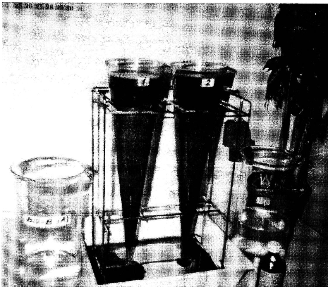
Rys. 8. Przemywanie prób gruntu przy użyciu Bio-b(a) Fig. 8. The soil washing process by Bio-b(a)
