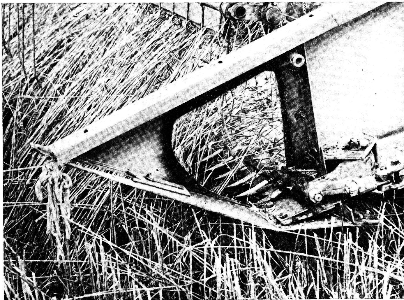
Rys. 4. Otwór z boku listwy tnącej zespołu żniwnego kombajnu KZS-3 „Bizon”
