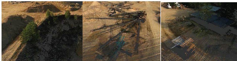
Rysunek 2. Zbędne elementy chmury punktów (autor: Dominik Słowik) Figure 2. Superfluous elements of a point cloud (author: Dominik Słowik)
