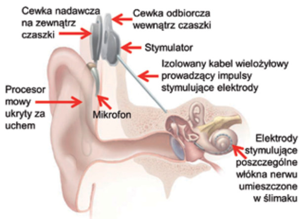
Ryc. 3. Ogólna budowa implantu ślimakowego. Schemat opracowany przez autora z wykorzystaniem rysunku z Wikipedii (domena publiczna) umieszczonego pod adresem https://pl.wikipedia.org/wiki/Implant_ślیمakowy#/media/File:Cochlear_implant.jpg
