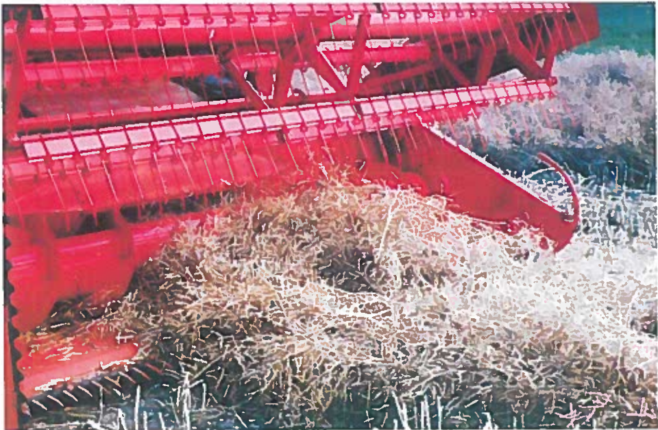
Fot. 6. Kombajn omlacający pokosy metodą „podcinania ścierniska”.
