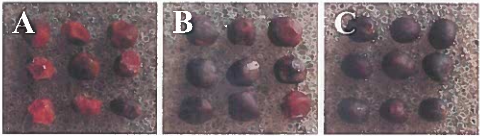
Fot. 10. Wpływ dojrzałości nasion i warunków przechowywania (temperatura 30°C; wilgotność 11%; obciążenie 300 kPa; czas przechowywania 40 dni) na deformację nasion rzepaku.
