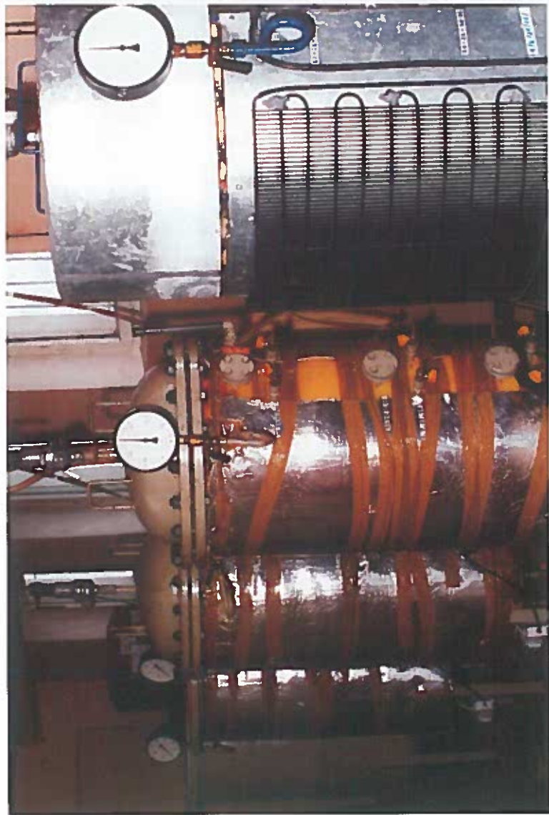
Fot. 9. Bateria komór ciśnieniowych symulujących silosy przemysłowe. A Komora z instalacją schładzającą; B, C, D komory z instalacją ogrzewającą Pic. 9. Battery of pressure chambers simulating industrial silos. A with cooling installation; B, C, D with heating installation;
