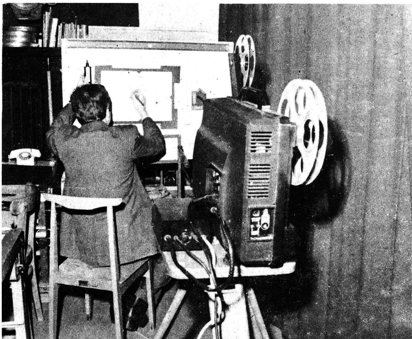
Rys. 1. Analiza ilościowa materiału filmowego za pomocą projektora Bolex
