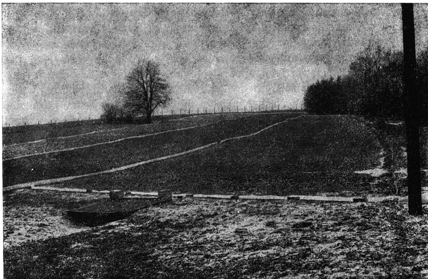
Rys. 1. Stok doświadczalny na Stacji Naukowej IG PAN w Szymbarku (stan z lat 1968-1970). Trzy odizolowane pola szerokości 13 m do pomiarów spływu powierzchniowego. Poniżej widoczne stanowisko do pomiarów spływu śródglebowego
