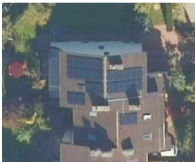
Rys. 1. Instalacja fotowoltaiczna (PV) o mocy 9,9 kWp Fig. 1. Photovoltaic installation (PV) with power of 9,9 kWp
