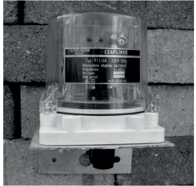
Fot. 2. Przełącznik zmierzchowy typ. PFZ-5B produkowany w 1980 roku przez firmę Telkom Telcza Fot. 2. Automatic wight light switch made by the company Telkom Telcza in 1980. Stowarzyszenie Byłych Pracowników Zakładu Telcza w Czaplisku https://telkomtelcza.pl
