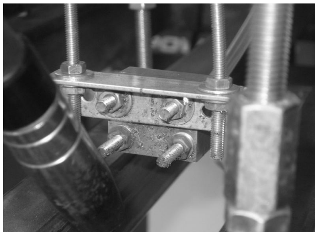
Rys. 3. Mikrojetowa dysza chłodząca; na pierwszym planie widać końcówkę spawalniczą Fig. 3. Microjet cooling injector with the welding end in the foreground
