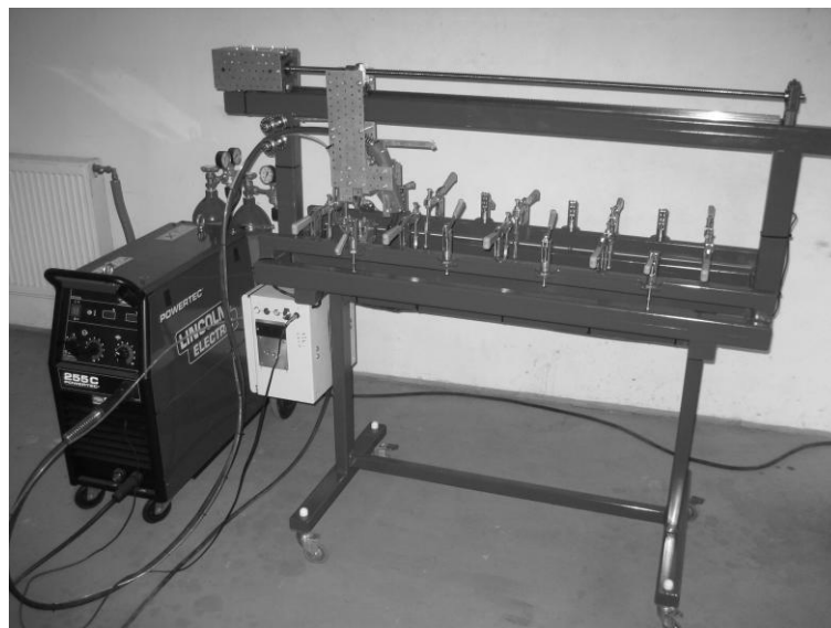
Rys. 4. Stanowisko badawcze składające się ze stołu oraz półautomatu spawalniczego Fig. 4. Workplace constructed of a table and a semi-automatic welder
