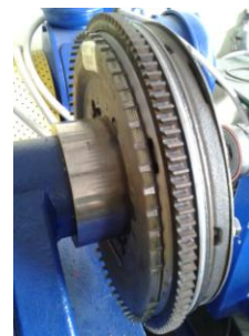
Rys. 3. Dwumasowe koło zamachowe LuK 415 0168 10 montowane w pojazdach Ford i Jaguar
