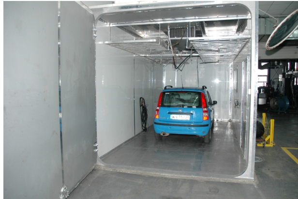
Rys. 5. Komora SHED wraz z widocznymi workami kompensacyjnymi Fig. 5. SHED chamber with the visible compensation bags
