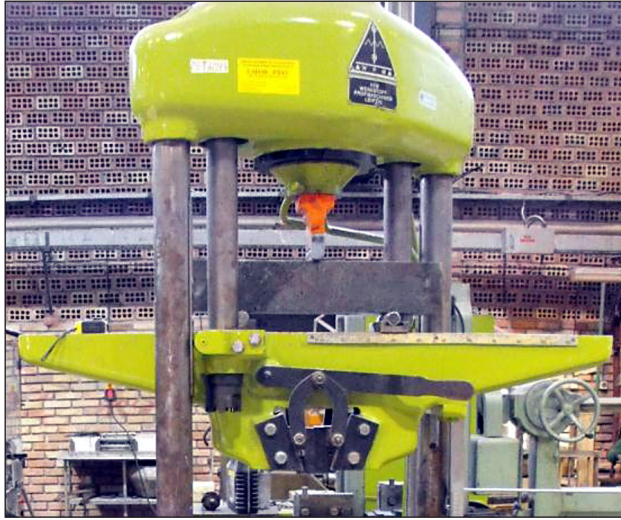
Rys 3. Widok próbki prostokątnej 10×10×40 cm podczas badania wytrzymałości na zginanie wg [PN-EN 12390-5]
