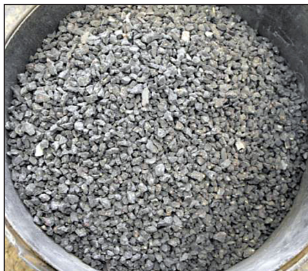
Rys. 5. Wysokowartościowe kruszywo recyklingowe frakcji 4–8 mm użyte do betonu w celu wykonania elementów badawczych
