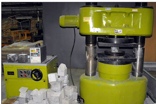
Rys. 1. Badania w maszynie wytrzymałościowej próbek kostkowych sześciennych 10×10×10 cm celem określenia wytrzymałości na ściskanie betonu
