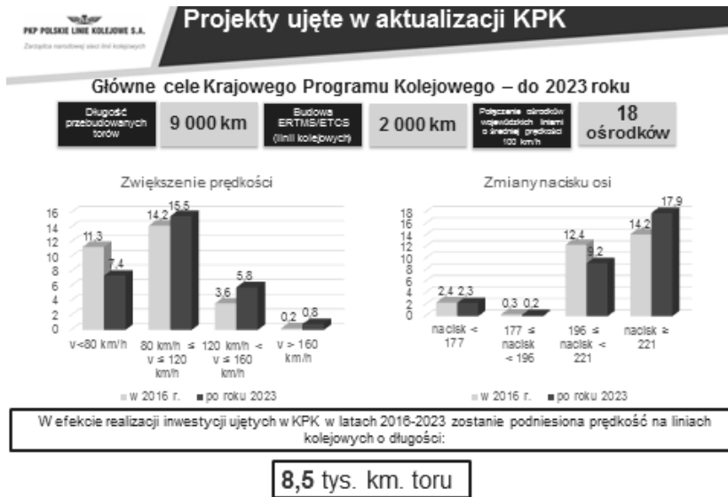
Rys. 2. Przewidywane efekty modernizacji linii kolejowych w Polsce [10]
