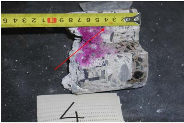
Ryc. 8 Odwiert TR-4 – głębokość karbonatyzacji około 42 mm Fig. 8. Core number TR-4 – depth of carbonation app. 42 mm
