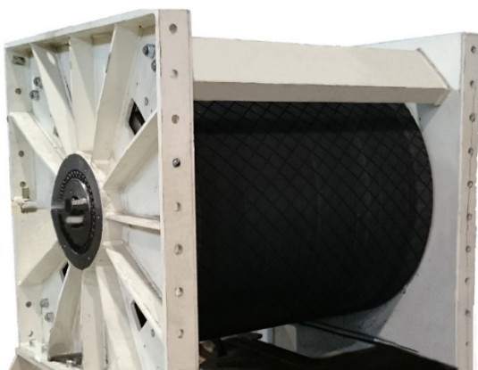
Rys. 13. Prototypowy silnik z wirnikiem zewnętrznym o mocy 250 kW [22]
