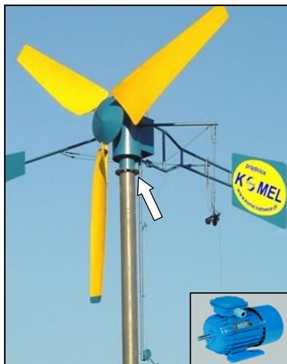
Rys. 14. Doświadczalna elektrownia wiatrowa z prądnicą z magnesami trwałymi o mocy 6 kW
