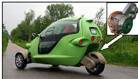
Rys. 1. Samochód elektryczny Re-Volt z silnikiem elektrycznym o mocy 14.9 kW
