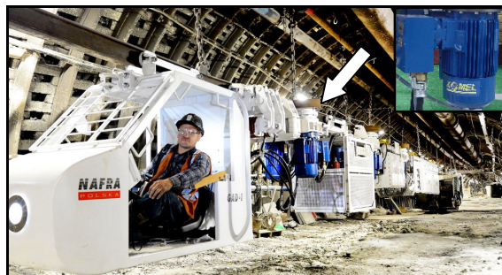
Rys. 11. Silnik z magnesami trwałymi w zastosowaniu w bardzo ciężkich i wymagających warunkach pracy
