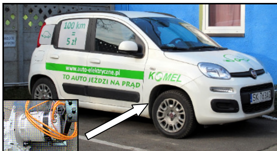
Rys. 2. Samochód elektryczny Fiat Panda z silnikiem elektrycznym o mocy 41 kW
