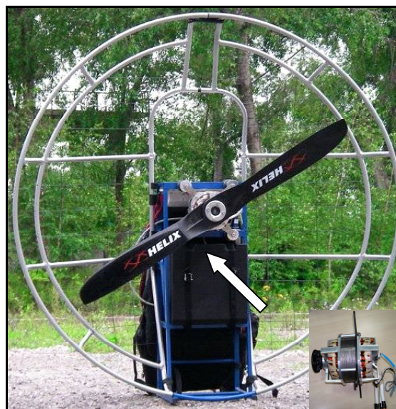
Rys. 8. Prototypowa paralotnia plecakowa z napędem elektrycznym
