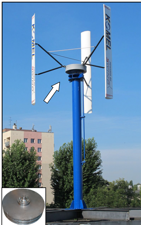
Rys. 15. Przykładowe zastosowanie prądnicy z magnesami trwałymi z wirnikiem zewnętrznym
