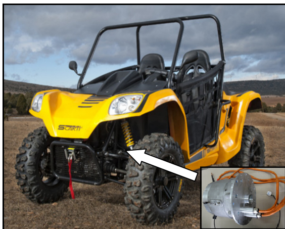
Rys. 5. Pojazd sportowo rekreacyjny [24] napędzany silnikiem z magnesami trwałymi o mocy 14,9kW
