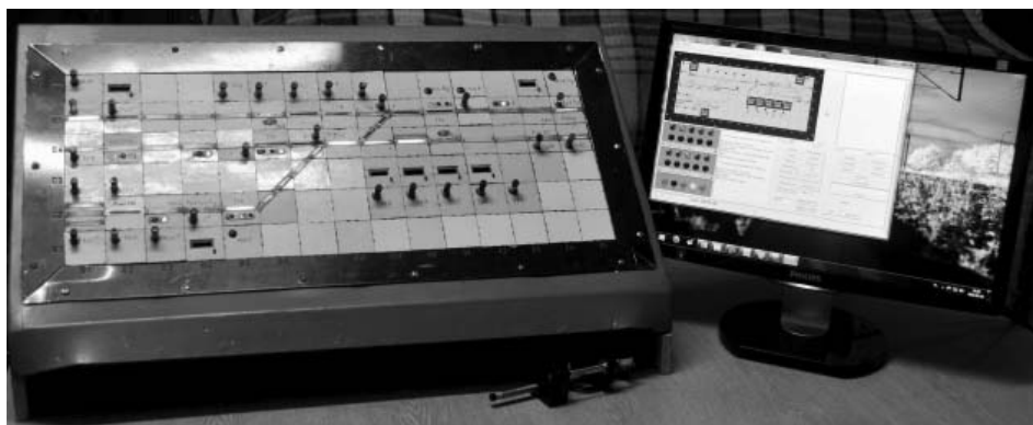
Rys. 4. Widok stanowiska symulatora z rzeczywistym pulpitem nastawczym
