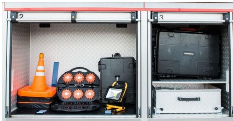
Rys. 8. Dyski sygnalizacyjne M-Flare, jako światło ostrzegawcze
