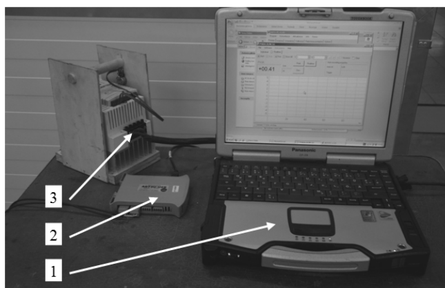
Rys. 6. Widok elementów układu pomiarowego stanowiska: 1 – komputer pomiarowy, 2 – moduł pomiarowy typu ADT4U-USB, 3 – przetwornik częstotliwości
