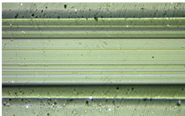
Rys. 8. Bruzda (rysa) na powierzchni osłony twarzy stosowanej w helmie KZPT_2012
