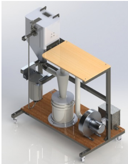
Rysunek 3 Wizualizacja projektu stanowiska dydaktycznego do badań procesu erozji wykonana w programie SolidWorks
