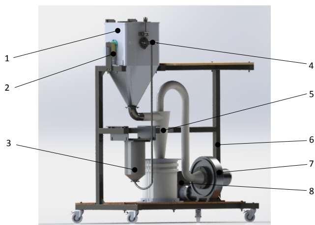
Rysunek 1 Schemat mobilnego stanowiska dydaktycznego do badania procesu erozji:
