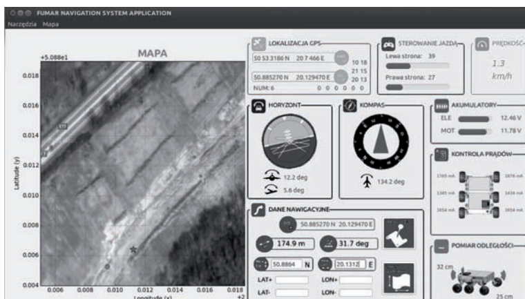
Rys. 9. Okno główne aplikacji do nawigacji i sterowania jazdą robota Fig. 9. Main application window to navigate and robot steering
