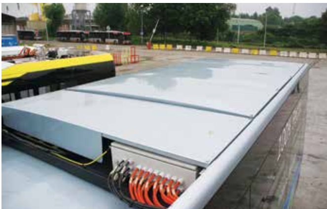
W Irizarze i2e pakiet baterii zlokalizowano na dachu pojazdu
