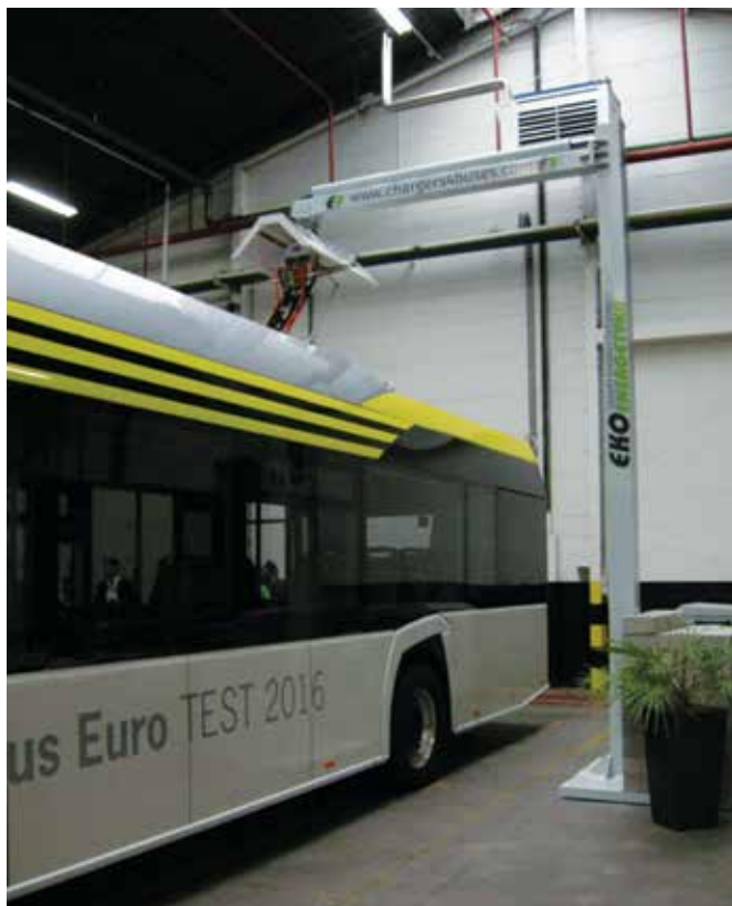
Solaris Urbino 12 electric podczas procesu doładowania baterii z pomocą pantografu
