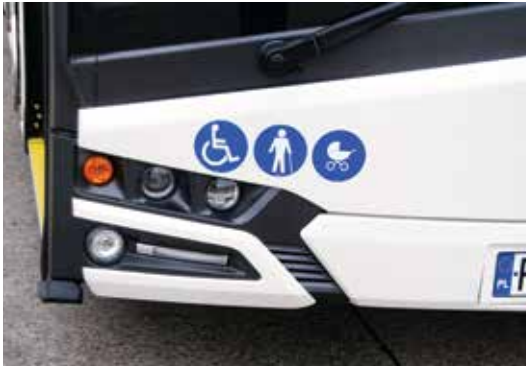
Jednym z charakterystycznych elementów jest nowy kształt przednich reflektorów z lampami w technologii LED
