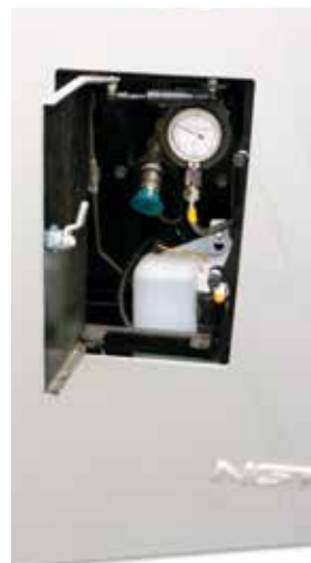
Złącze umożliwiające zatankowanie butli ze sprężonym gazem ziemnym w Mercedesie Citaro NGT
