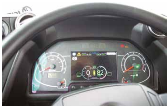
Na desce rozdzielczej pojawiła się nowa zakładka informująca kierowcę o maksymalnym zasięgu możliwym do przejechania
