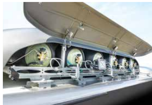
Charakterystycznym elementem Citaro NGT jest obudowa butli, zamontowana na dachu pojazdu. Fot. Daimler
