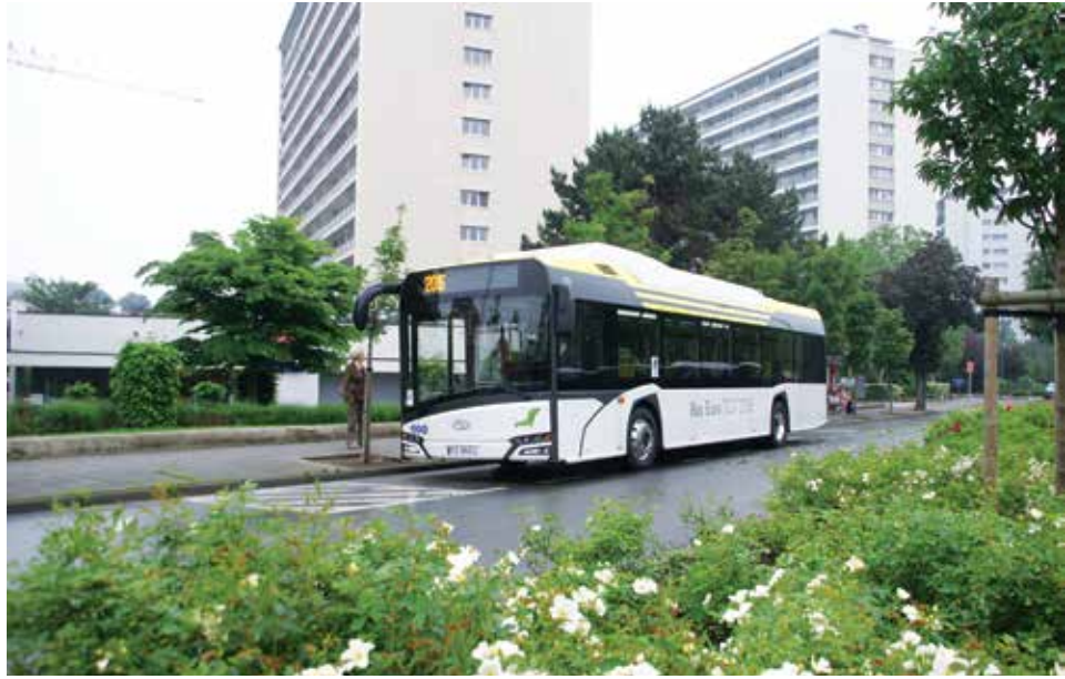
Bryła Solarisa newUrbino 12 electric z charakterystycznym pasem nadokiennym i zintegrowaną osłoną aparatury elektroenergetycznej
