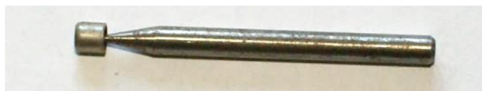
Zdjęcie 5. Niewybuch spłonki zapalającej nakłuciowej – grot iglicy zagłębiony w spłonce [13]
