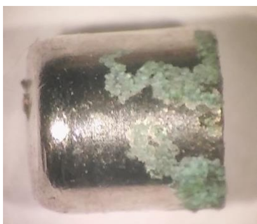
Zdjęcie 8. Ogniska korozji na spłonce zapalającej nakłuciowej 53-KW-006 [13] Photograph 8. Centres of corrosion on pricker igniting cap 53-KW-006 [13]
