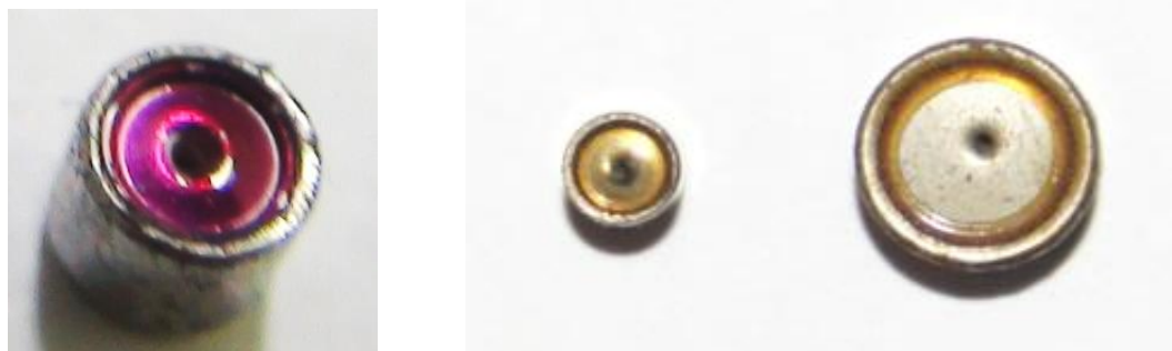
Zdjęcie 4. Niewybuchy spłonek zapalających nakłuciowych stwierdzone w trakcie badań wrażliwości na nakłucie grotem iglicy badawczej [13]
