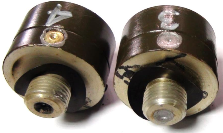
Zdjęcie 2. Słonka zapalająca uderzeniowa KWM3 zamontowana w pocisku granatnikowym PG-7 [13]:
