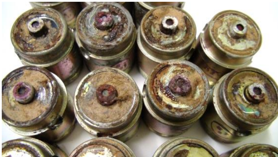
Zdjęcie 9. Skorodowane spłonki DC w zapalnikach DC-1 [13]
