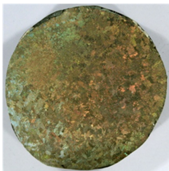
Rys. 1. Makrostruktura stopu Al-33%Cu po odlewaniu – przekrój poprzeczny
