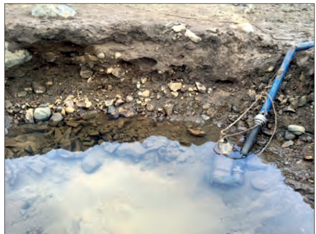
Ryc. 2. Płytki wkop w celu obserwacji wód podziemnych i poboru próbki wody
